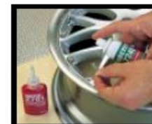
Loctite 7240 Öldőszermentes aktivátor, amely növeli a kikeményedési sebességet passzív felületeken, például rozsdamentes acélon, alumíniumon, galvanizált vagy passzívált fémeken.
