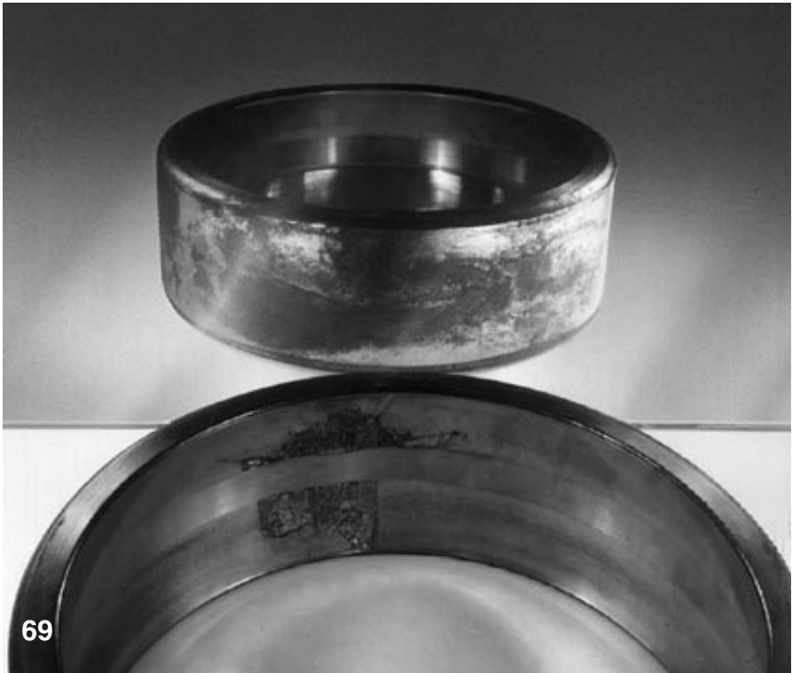
69.ábra Egy beálló görgőscsapágy külső futópályáinak lepattogzása. Előrehaladott illesztési korróziónak megfelelő terület a külső gyűrű felüle- tén (a gyűrűt egy tükör elé helyezték a fényképezéshez). A korrózió kifejlő- dését térfogat növekedés kísérte, mely túlterhelést és a gyűrű deformációját okozta. Az eredmény idő előtti anyag- kifáradás és lepattogzás.
