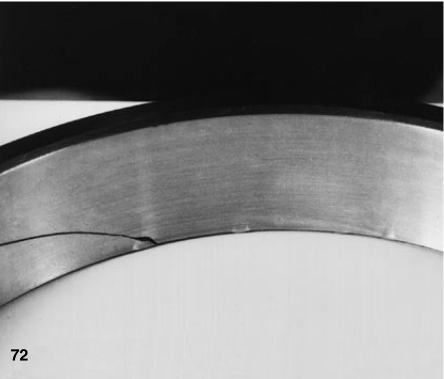
72.ábra Egy beálló golyóscsapágy eltört külső gyűrűje. Az alsó szélén látható benyomódásokat durva bánásmód okozta és a repedés a benyomódások egyikéből keletkezett.
