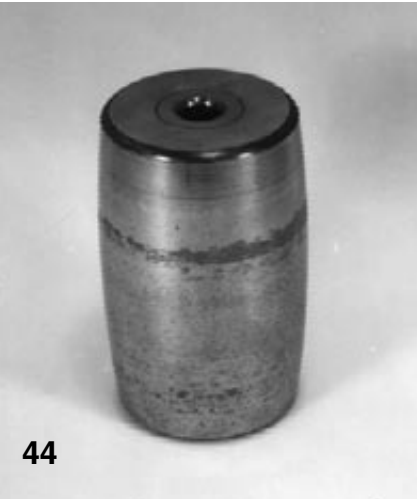
44.ábra Veszélyes felületi károsodás kör alakú szalag formájában egy szférikus görgőscsapágy görgőjén
