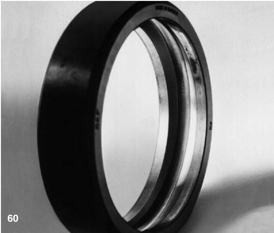
60.ábra Mély hornyú golyóscsapágy külső gyűrűje, melynek a tengellyel szöghibája volt, ezért a golyópálya oválissá vált. Az eredmény azonos az ovális összenyomással, lásd 31. oldal
