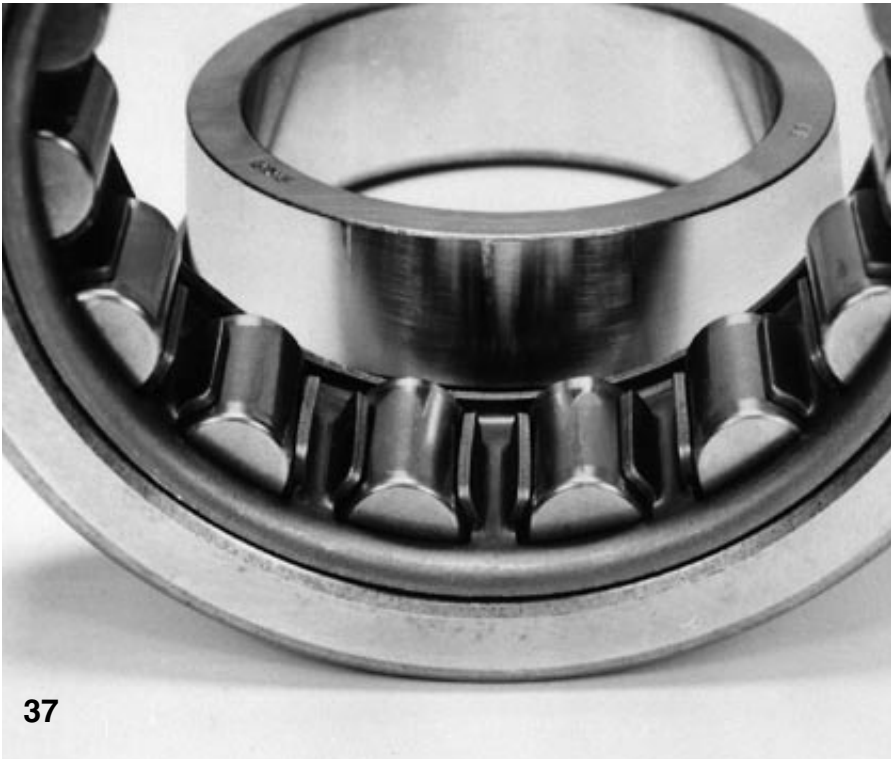
37.ábra Hengergörgős csapágy elkenődési sávokkal a belső gyűrű futópályáin. Oka, hogy a görgőskoszorú, -kosár ferdén kerül be, forgatás nélkül
