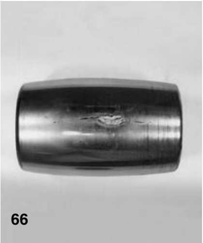
66.ábra Egy beálló görgőscsapágys görgőjének lepattogzása, melyet mélyrozsdá okozott
