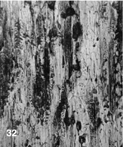
32.ábra Egy szférikus görgőscsapágy görgőjének az elkenődött felülete – 100 × nagyítás
