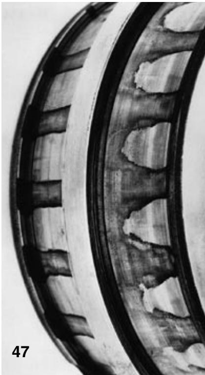
46.ábra Egy hengergörgős csapágy külső gyűrűjének mélyrozsdája
