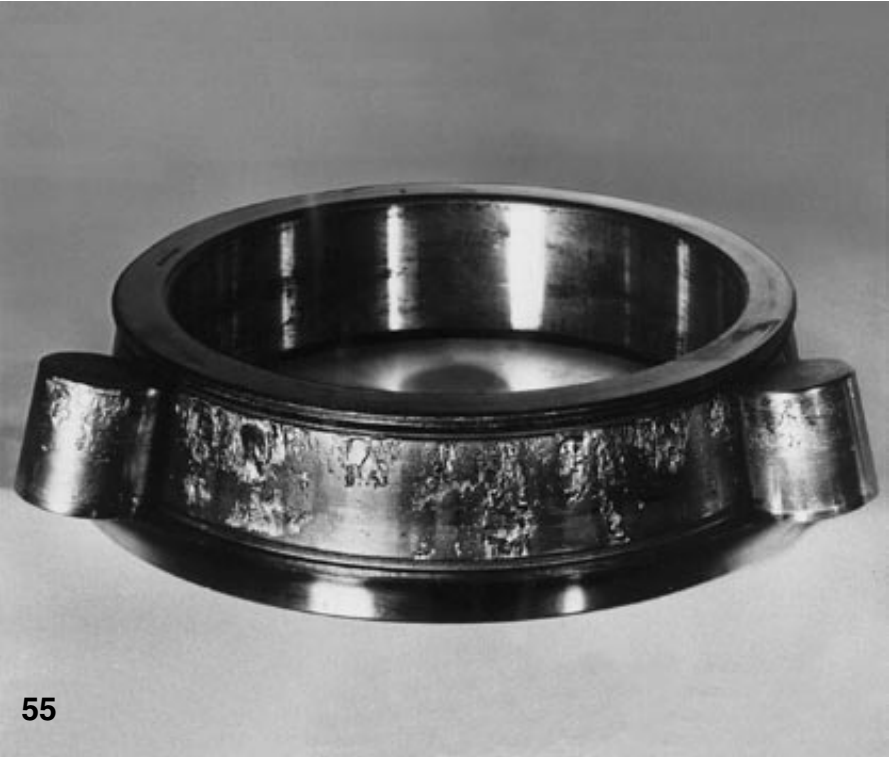
55.ábra Egy kúpgörgös csapágy belső gyűrűjének lepattogzása. Oka a túl nagy terhelés és a nem megfelelő kenés
