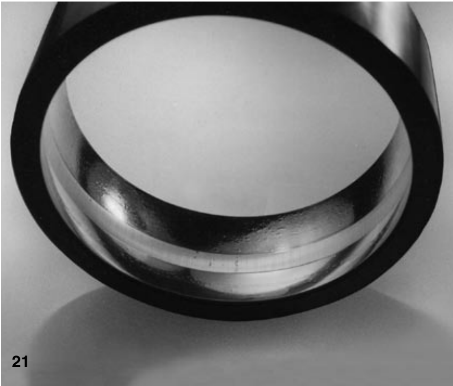
21. ábra Egy hengergörgő tükröszerű felülete, az elváltozás oka a kevés kenőanyag.
