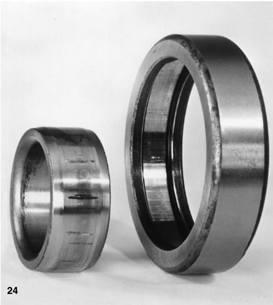
24. ábra Vibrációnak kitétt hengergörgőscsapó-gyűrű. A belső gyűrű változtatta helyzetét.
