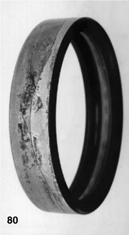
79.ábra Beálló görgőscsapágó belső gyűrűje illesztési korrózióval és a gyűrűn teljesen keresztülhatoló repedéssel. A repedést az illesztési korrózió okozta.
