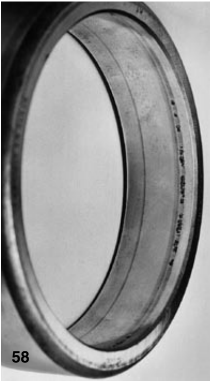
58.ábra Túl nagy axiális terhelésnek kitett beálló golyóscsapágy külső gyűrűje. Lepattogzás a terhelési zónában
