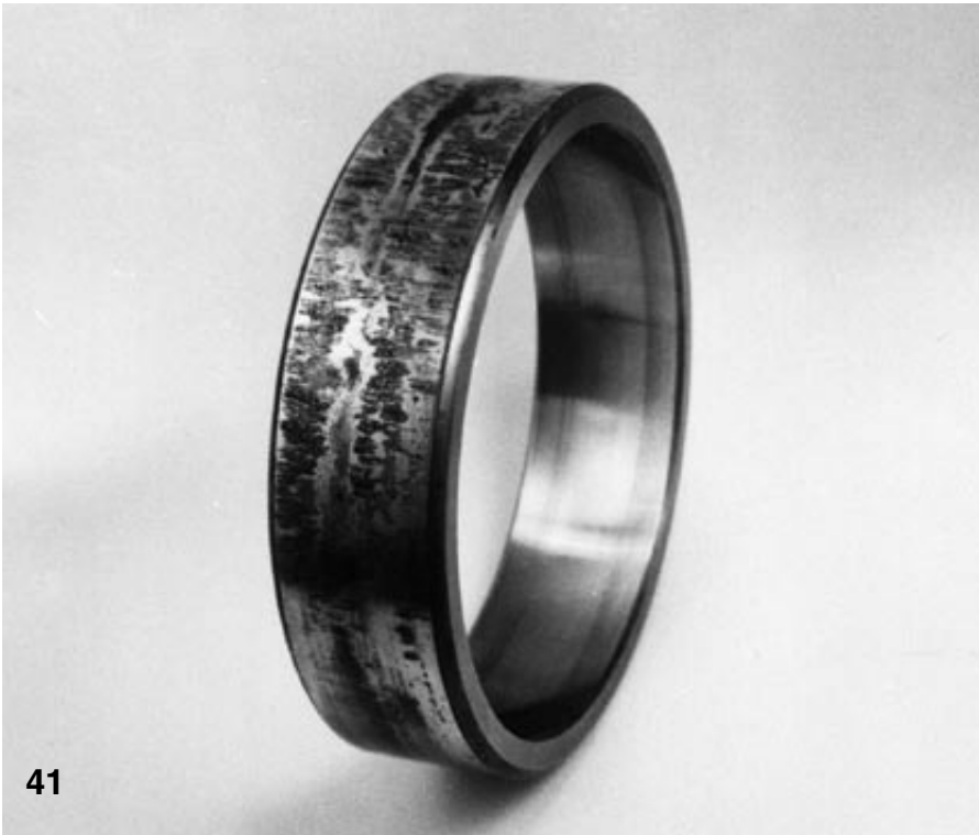
41.ábra Egy beálló görgőscsapágy külső gyűrűjének elkenődése a külső felületen. A házfurat anyaga a csapágy gyűrűre kenődött
