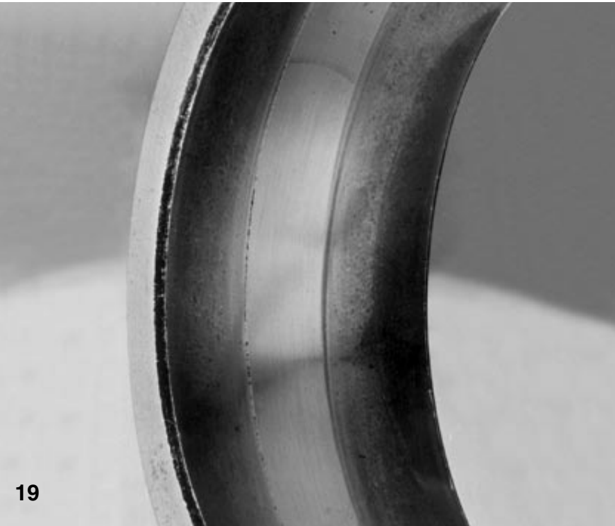
19. ábra Egy beálló görgőscsapágy külső gyűrűjének futópályái, melyeket a koptató részecskék elkoptattak. Könnyen látható a kopott és nem ko-pott felületeket elválasztó vonal
