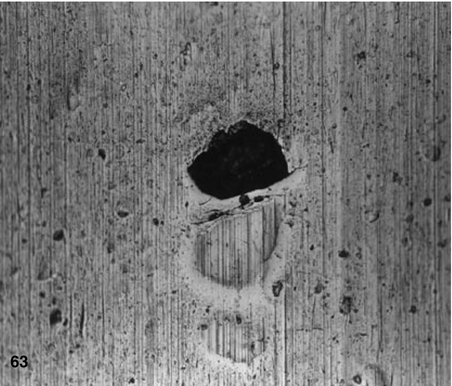
63.ábra Lepattogzás (sötét folt), mely a szomszédos benyomódás következtében keletkezett – 100 x nagyítás
