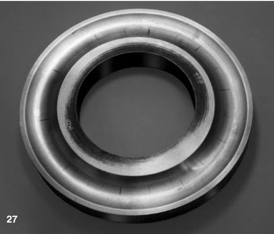
27. ábra Egy axiális golyóscsapágy tárcsája, melyet álló állapotban túlterhelés ért. A benyomódások keskenyek és radiális irányúak, nem szférikusak, mint a golyóscsapágyakban.
