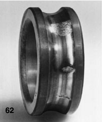
62.ábra Egy mély hornyú golyóscsapágy belső gyűrűjén keletkezett lepattogzás különböző állapotai. A gyűrűt szorosan illesztették a tengelyre, amikor a külső gyűrűt ütések érték, tehát a szerelési erőhatást a golyók közvetítették, így benyomódások keletkeztek.
