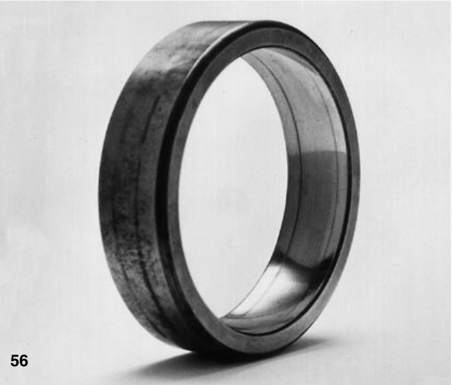
56.ábra Egy beállló golyóscsapágy külső gyűrűje. A csapágyat túlságosan felnyomták a kúpos ülékre. A csapágy keveset forgott, amikor felfedezték a károsodást. A lepattogzás nemsokára bekövetkezett volna, ha a csapágy tovább üzemel.
