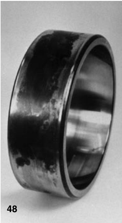
49.ábra Kiterjedt illesztési korrózió egy beálló golyóscsapágy furatában
