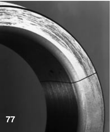
77.ábra Beálló görgőscsapágy belső gyűrűjének átrepedése a homlokfelület elkenődése következtében. A gyűrűt úgy szerelték, hogy egy távtartó gyűrűre támaszkodjon, melynek azonban a tengely illesztése nem volt elég szoros. Következésképpen a távtartó a tengelyhez és a csapágygyűrűhöz képest forgott.
