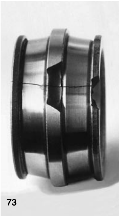
73.ábra Egy beálló görgőscsapágy repedt belső gyűrűje. Egy görgőt ki-szedtek, hogy meg lehessen vizsgálni a bal oldali ábra futópályáját. A görgőt visszaütötték a helyére kalapáccsal, amikor a közép karimából letörtek egy darabot. Az ütest egyik görgőn át mér-ték a másik görgősorból, így a külső karimából is letört egy darab. Egyide-jűleg a gyűrű is keresztültrepedt.
