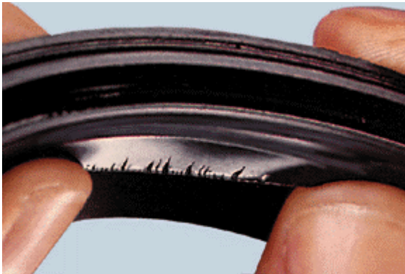
Hő okozta károsodás
